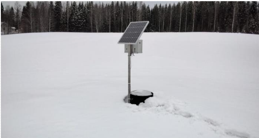
Prototyyppi etäohjattavasta kaivosta. Kuva: Jouni Kolehmainen
