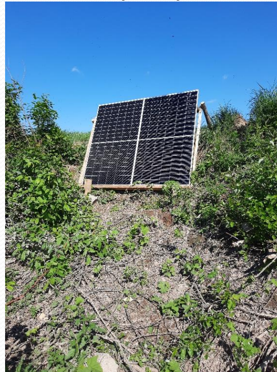
Aurinkokennotoiminen pumppu Vesienhallinta vesiensuojelussa 2 (VesiHave2) hankkeen Sievin säätösaloja/altakastelukentällä. Kuvat: Markus Sikkilä
