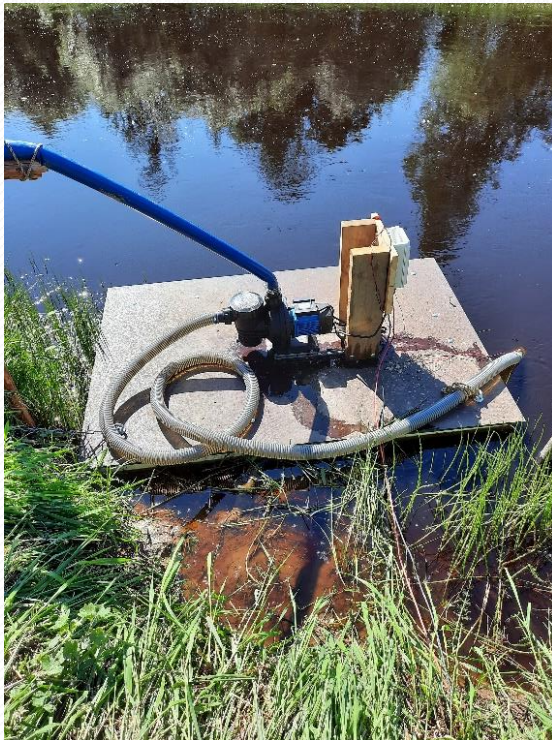
Aurinkokennotoiminen pumppu Vesienhallinta vesiensuojelussa 2 (VesiHave2) hankkeen Sievin säätösaloja/altakastelukentällä. Kuvat: Markus Sikkilä
